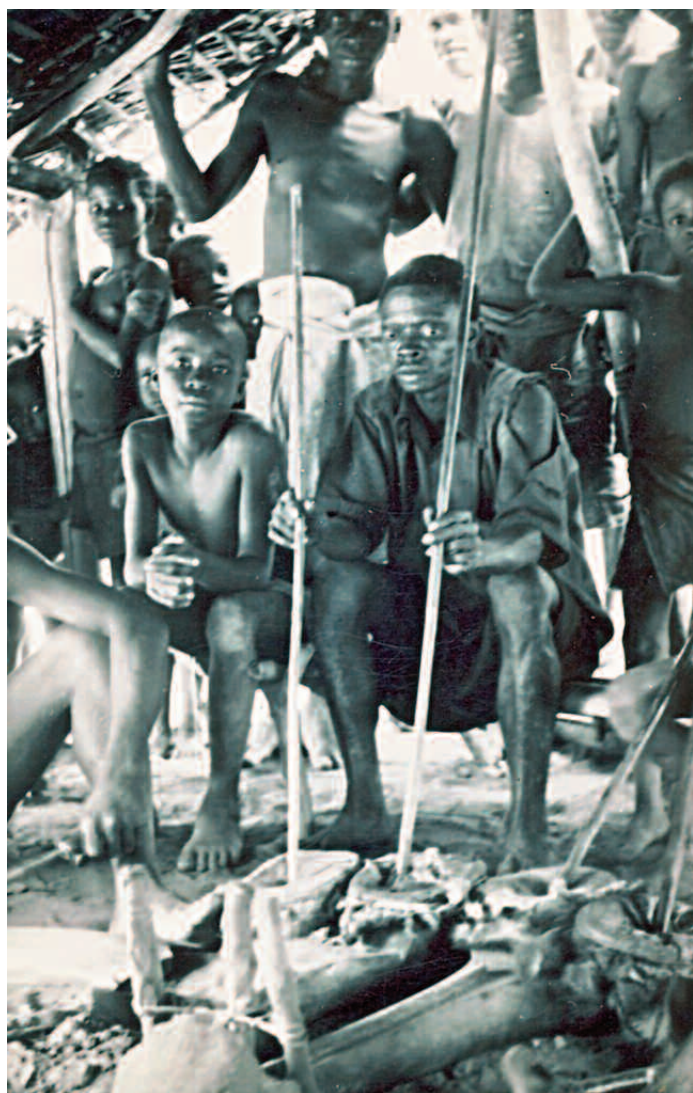
Des garçons actionnent habituellement les soufflets. Forge dans le village lele de Kabombo Bweto ( nord-est du Territoire d'Idiofa ) ( photo Henri Nicolai, 1955/37 ).
