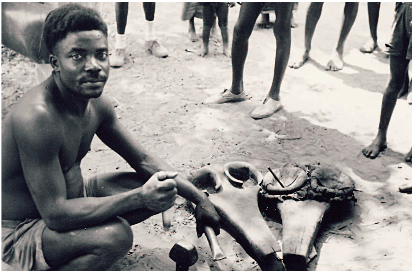
La forge est le domaine exclusif d'hommes pourvus souvent de pouvoirs particuliers, en même temps guérisseurs, par exemple. Certains groupes, comme les Hungana ( T. de Masi Manimba ) sont réputés pour la qualité de leurs produits. Outillage de la forge : l'enclume, le marteau, les soufflets actionnés à la main ( photo Henri Nicolai, 1955/21 ).
