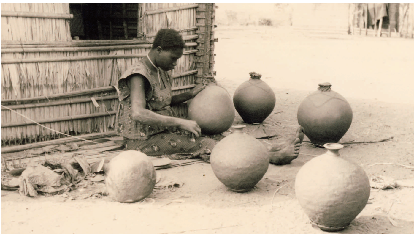
La fabrication des poteries est une activité féminine. Village mbunda d'Ingungu, T. d'Idiofa. Un tesson sert de tour rudimentaire. Jarres prêtes pour la cuisson (photo Henri Nicolai, 1957/30A).
